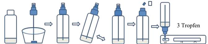
3. Nehmen Sie die Testkassette aus dem Beutel und legen Sie sie auf einen Tisch. Geben Sie dann 3 Tropfen der Probe senkrecht in die Probenvertiefung (füllen Sie die Probenvertiefung auf).
